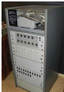
Figura 3 – Sistema de funcionamento automático por comando valvulado Zeiss.
