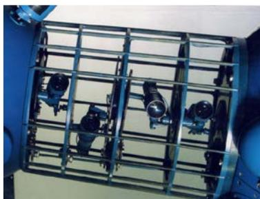
Figura 6 – 4 projetores Zeiss dos planetas (lanternas).
